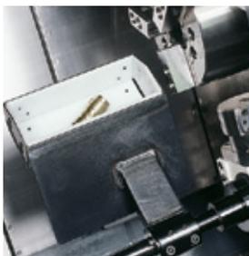
当选择较大的主轴棒料加工能力时，相应地选择具有较大规格参数的零件接料器 (op.)
