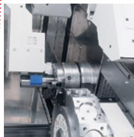
接料器从右侧卡盘卸载零件。它是爪型零件接料器。通过移动右侧主轴拉出零件。
