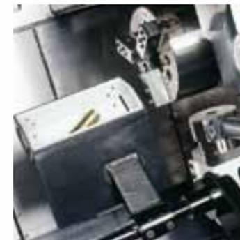
当选择较大的主轴棒料加工能力时, 相应地选择具有较大规格参数的零件接料器 (op.)
