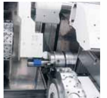
接料器从右侧卡盘卸载零件。它是爪型零件接料器。通过移动右侧主轴拉出零件。
