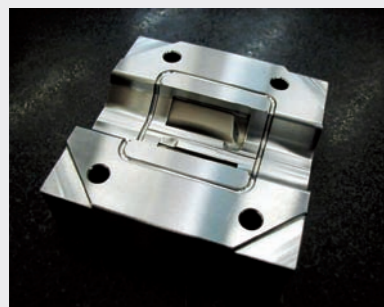
4. 材料: NAK55 切削时间: 1小时20分
