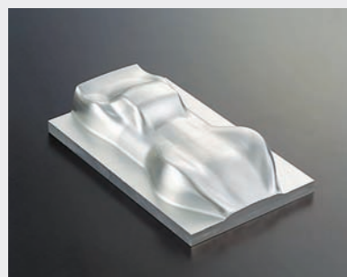
1. 材料: NAK55 切削时间: 2小时30分
