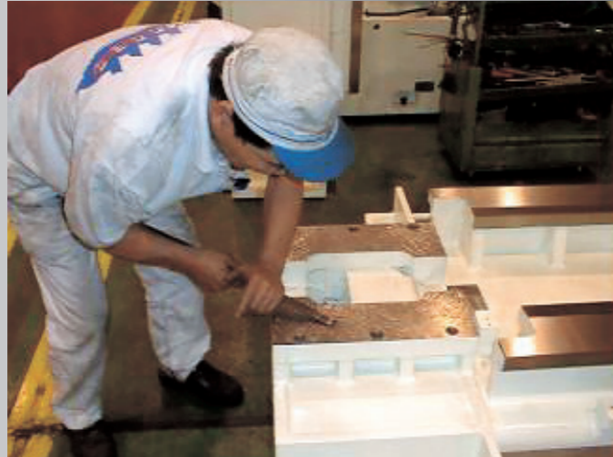
全面刮研工艺 所有机床导轨滑动面及组装结合面皆为刮研加工 (1平方英寸约25点)
