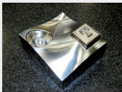
3. 材料: NAK55 切削时间: 1小时28分
